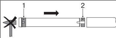
Montieren Sie den Rohrantrieb mit entsprechendem Laufring (1) und Mitnehmer (2). Schieben Sie den Rohrantrieb mit dem vormontierten Laufring und Mitnehmer formschlüssig in die Welle ein. Achten Sie auf guten Sitz des Laufringes und des Mitnehmers in der Welle.
